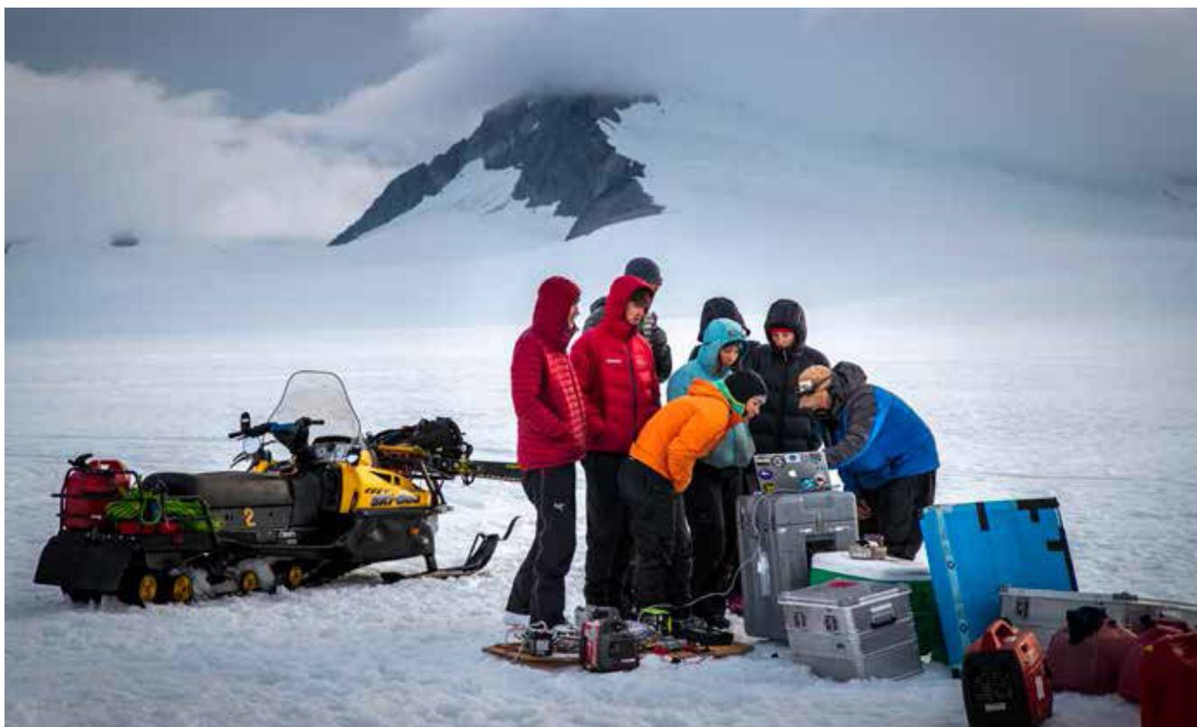
*Izotzaren sakonera neurtzeko GPR radar bat (Ground Penetrating Radar) bat erabiltzen. Puntu horretan izotzaren sakonera 1000 metrokoa zen.*
